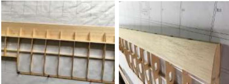
44. Beplankungen an Vorderkante besäumen, Nasenleiste aus 8-mm-Balsa aufleimen und verschleifen
