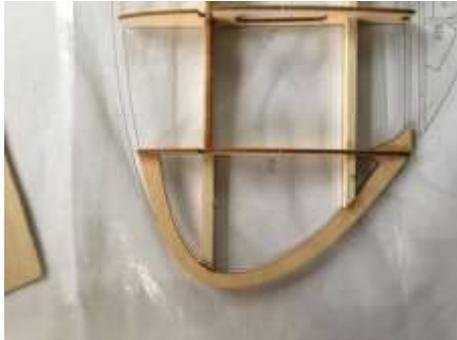
36. Bohrungen für Scharniere in Sperrholzteile B19 und B20 gem. Bild anzeichnen und bohren
