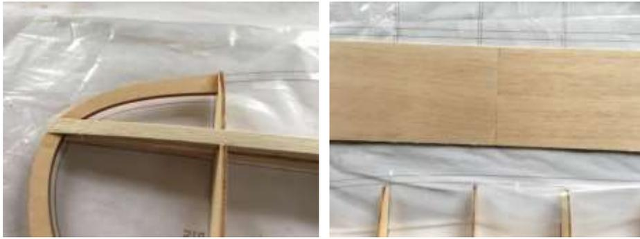
43. Untere Beplankung an der Vorderkante anheben, an die Rippen pressen und verkleben. Ggf. Leiste aus Restholz unterlegen. Danach obere Beplankung aufbringen.
