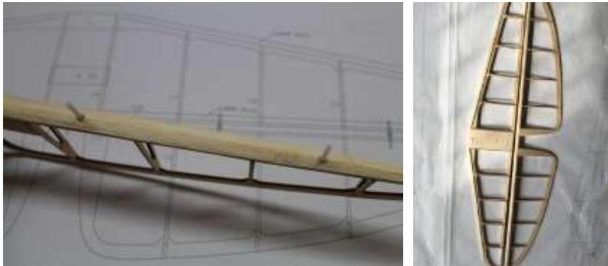
31. Falls gewünscht, wird das Höhenruder mittels M3 Schrauben am Rumpf befestigt und ist somit für einen leichteren Transport abnehmbar.
