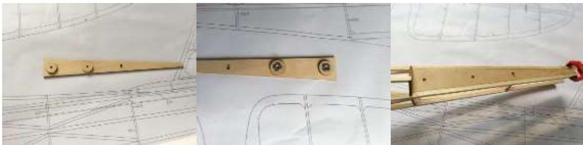
14. Seitenruder lt. Bauplan zusammenbauen. Behelfsmäßig eingespannte Sperrholzstreifen verhindern einen evtl. Verzug während des Klebens
