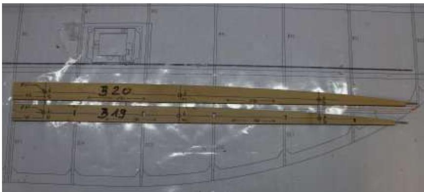
37. 6x6-mm-Balsaleisten in den Ausschnitten der Rippen des Querruderausschnitts verkleben, danach Sperrholzteil B20 verleimen
