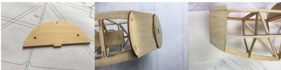
22. Motor in den Rumpf einbauen und Kugellager auf Welle schieben. Anschließend die 3 Lagen 8-mm-Balsa nach dem Kugellager ausrichten, danach verkleben und verschleifen
