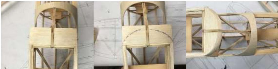
24. Das Hinterteil der Tragflächenauflage wird mit Balsastäben gefüllt
