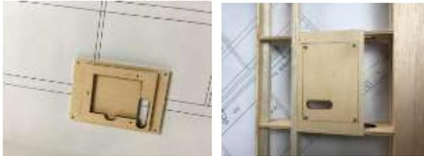
47. Arretierungsdübel einleimen. Obere und untere Wurzelbeplankung anpassen und verleimen. Achtung: Die obere Beplankung wird auf den Rippen, die untere Beplankung zwischen den Rippen verleimt.
