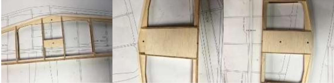
28a. Übergangskeil aus 5-mm-Balsa zuformen und auf Höhenleitwerksauflage aufkleben. Die Profelsehne muss parallel zur Höhenleitwerksauflage verlaufen.
