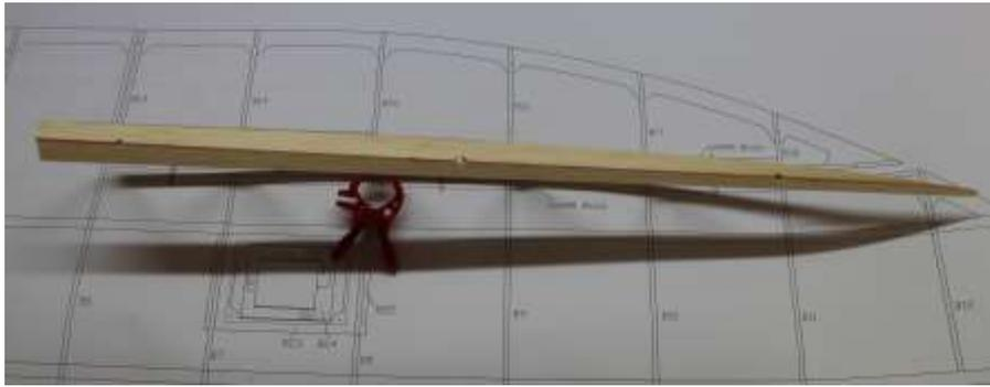
41. Querruder montieren, entsprechend dem Profilverlauf verschleifen und der Kontur der Tragfläche anpassen.
