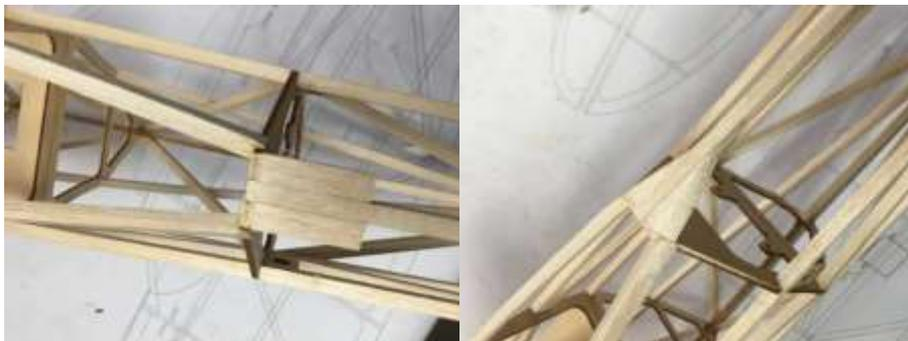
25. Installation der Bowdenzugrohre
