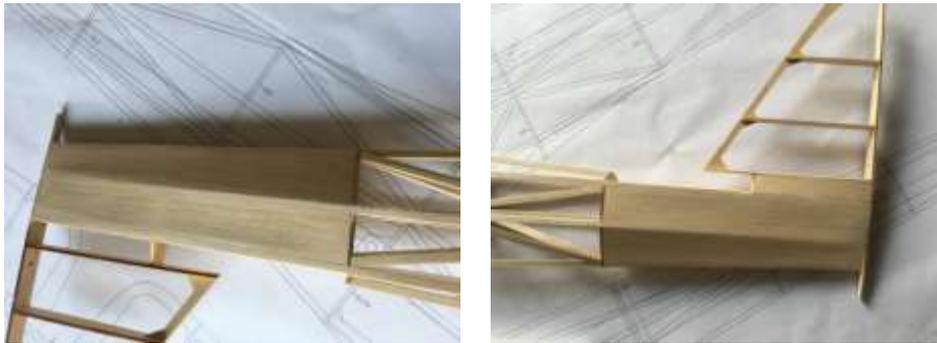
16. Die Vorderkante des Seitenruders wird mit 8-mm-Balsaleisten verstärkt und verschliffen, der Hecksporn wird aus 8-mm-Balsastücken geformt
