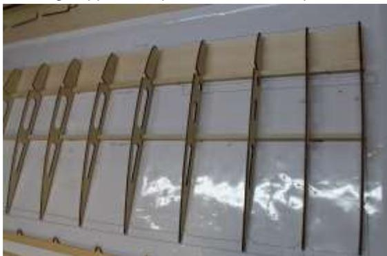
34. Rechen vorsichtig auf Rippen aufsetzen und diese sorgfältig danach ausrichten. Der Rechen muss sich bis zum unteren Hauptholm einschieben lassen. Endleiste an Rippenenden führen und diese danach ausrichten. Nach dem Ausrichten Rippen verleimen.
