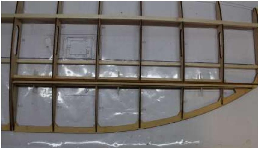
42. Führungsrohr für die Steckung einkleben
