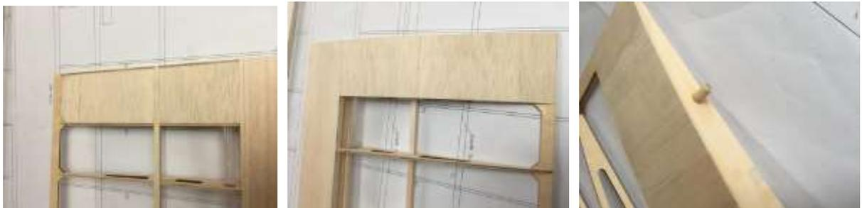
48. Der Rohbau ist somit fertig gestellt. Nachdem alle Bauteile sorgfältig verschliffen wurden, kann das Modell bespannt werden. Dazu empfehlen wir uneingeschränkt die transparente Bespannfolie von ORACOVER. Bitte beachten Sie genauestens die Verarbeitungshinweise der Folie und verwenden Sie ORACOVER Heißsiegelkleber an Kontaktflächen soweit sinnvoll.
