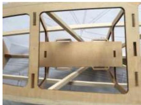
11. Die oberen Spanten und Verstärkungen aufsetzen und verkleben
