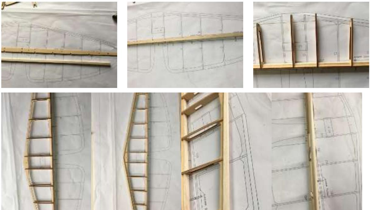
28. 2x Bauteile C5 miteinander verkleben und im Ausschnitt der Mittelrippen verleimen. Oberseite und Unterseite mit 2-mm-Balsa beplanken. Anschraubbohrungen auf Beplankung übertragen.
