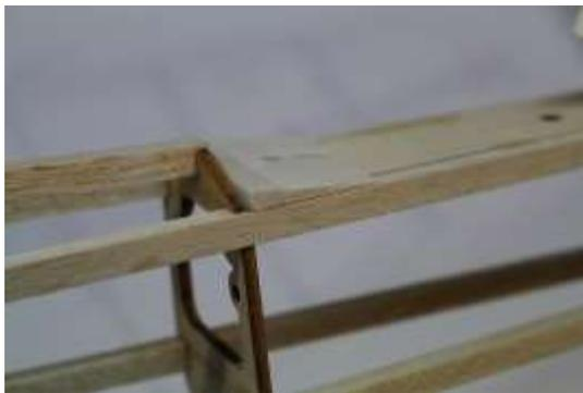
29. Bauteil C11 und 8-mm-Balsaleiste verkleben (Balsaleisten entsprechend verlängern). Bohrungen für Scharniere in Balsaleiste übertragen
