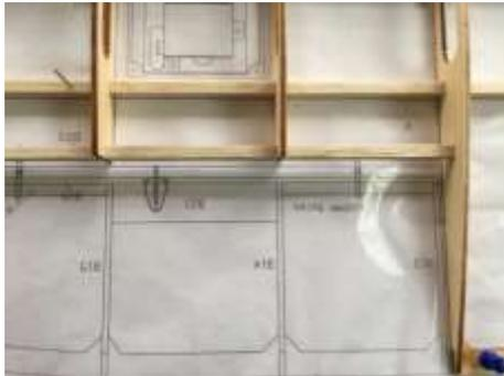
38. An die Vorderseite von Sperrholzteil B19 eine 6-mm-Balsaleiste verleimen, danach die Bohrungen für die Scharniere auf die Balsaleiste übertragen. Anschließend mit Hilfe der Bohrungen Scharnierlinie auf der Balsaleiste anzeichnen.
