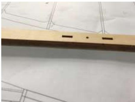
30. Teile für die beiden Höhenruder verleimen, anschließend beide Höhenruderteile und Bauteil C11 verleimen, Beidseitig die Übergangsfüllungen aus 8-mm-Balsa verleimen und dem Profil verlaufend verschleifen.
