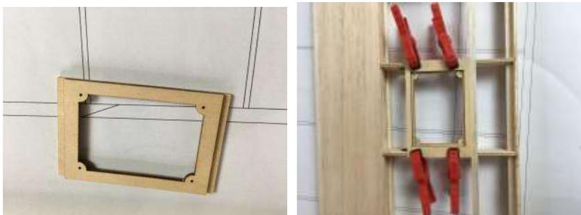
46. Servorahmen auf Deckel verleimen. Nach erfolgter Servomontage den Deckel im Grundrahmen verschrauben
