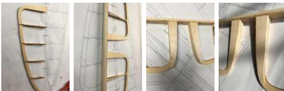
30a Vorderkante des Ruders spitz verschleifen. Anschließend die Balsaleiste der Dicke des Ruders entsprechend verschleifen.
