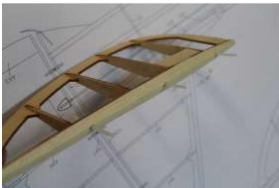
27. Sperrholzteil C12 und 6x8-mm-Balsaleisten wie gezeigt verkleben und die Rippen einsetzen. Die Sperrholz Vorderkante einsetzen. 6x8-mm-Balsaleisten an Vorderkante verkleben und anschließend verschleifen
