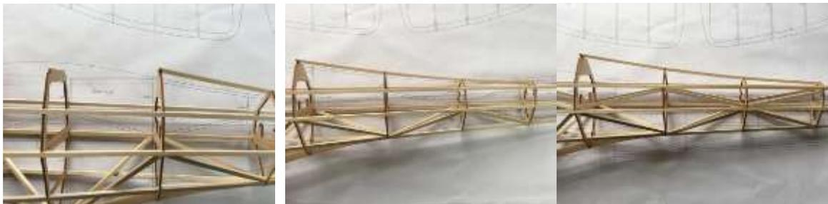
13. Die runden Verstärkungen auf das Sperrholzteil A35 kleben und die Zackenmuttern vorsichtig einschlagen. Das fertig gestellte Teil zwischen den Gurten verleimen
