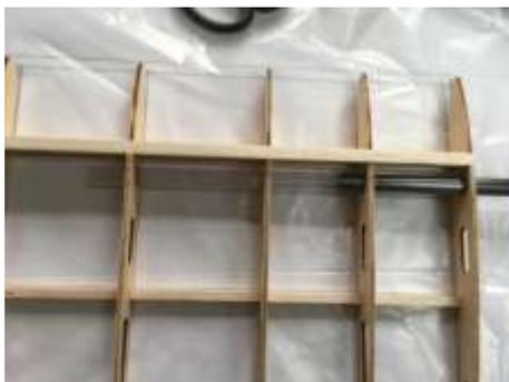
43. Randbögen verschleifen und Beplankung aus 2-mm Balsa vorbereiten
