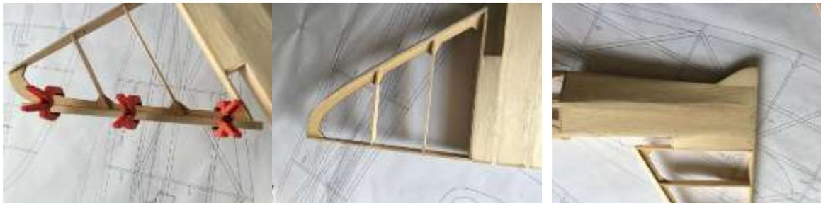
17. Bauteile A27 zusammenfügen und in den Rumpf kleben
