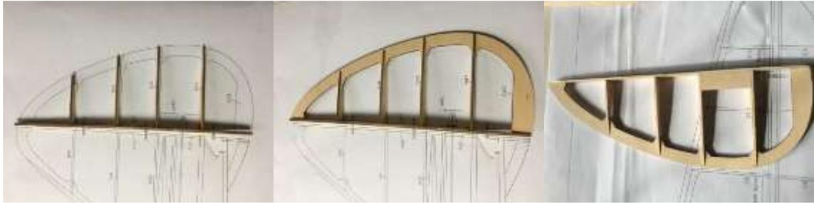
26a. Vorderkante mit 8-mm-Balsaleiste verkleben und spitz verschleifen. Danach Balsaleiste der Dicke des Seitenruders nach verlaufend verschleifen
